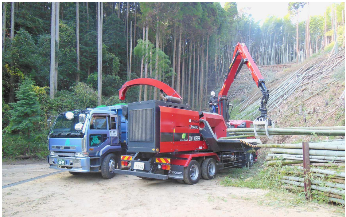
○移動式破碎機による破碎とチップ運搬車への積み込み作業
