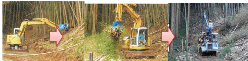
「バンブーカッター伐木・造材・集材」→「フォワーダ集材」
